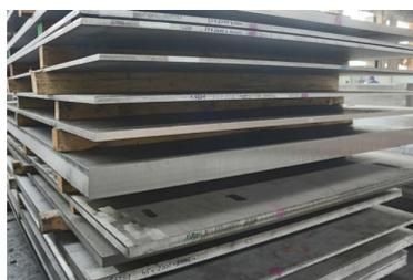
El material 1.4301 | 1.4307 posee una excelente cualificación de soldadura, una buena maquinabilidad y una alta resistencia a la corrosión. Después de la soldadura el material no esta resistente contra la corrosión intergranular. Almacenamos el material en la ejecución recocido de desolución y templado.
